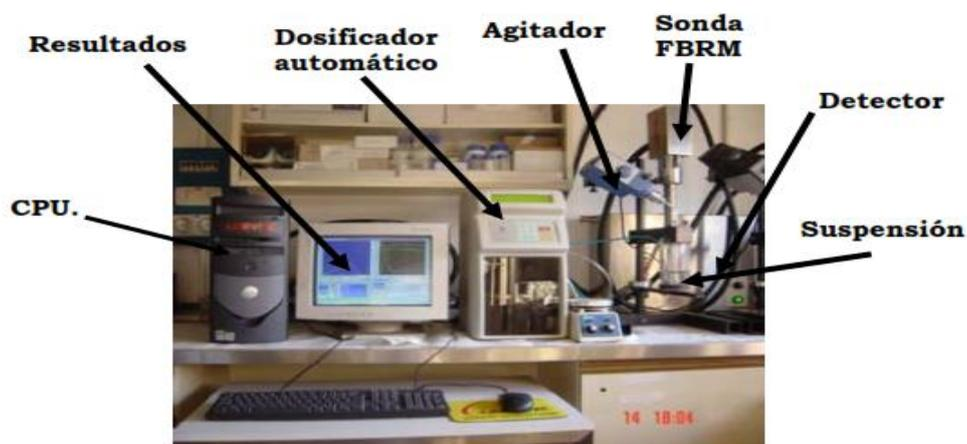
**Figura 3. Equipo de medida por reflexión de rayo enfocado “FBRM”**
